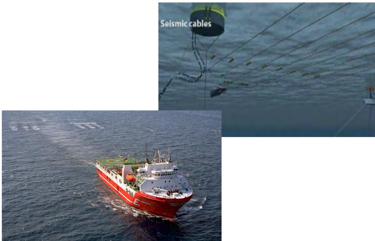
**Abbildung 27** – Reflexions-Seismik auf dem Meer. Im Schlepp des Schiffs sind die Anfänge der Streamer zu erkennen (links aus der Vogelperspektive, rechts aus der Fischperspektive).
