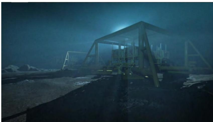
**Abbildung 29** – Virtuelle Darstellung eines „Template“ am Meeresboden. Die pyramidenstumpf-artigen Überbauten dienen als Schutz gegen Schleppnetze. (Statoil, 2011), Offshore Technology (2011), Teijin (2011).
