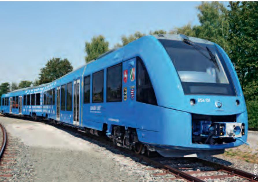
Die erste mit Wasserstoff betriebene Regionalbahn verbindet Buxtehude mit Cuxhaven: wo die Elektrifizierung zu aufwendig ist, eine bessere Lösung als Dieselloks.
